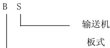
1000—输送机链板宽度为 1000(mm)、60—输送机中心轴线长度 60m。
